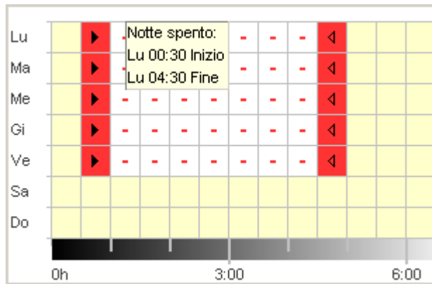
Fig. 55: Illuminazione stradale disattivazione nei giorni feriali
