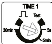
Se si desidera utilizzare la funzione ad impulso (ad es. per un temporizzatore luce scale)
