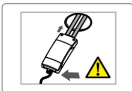
► Introdurre l'unità di potenza attraverso l'apertura del soffitto e fissare il sensore al soffitto con le molle in tensione
