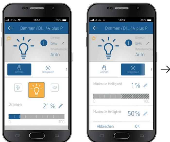
→ E' possibile selezionare funzioni come Regolazione luminosità, Luce scala, Comfort e Impostazioni (con curve di regolazione alternative).
