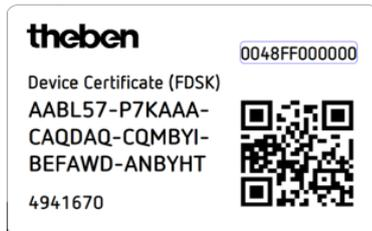
Dopo aver inserito l'FDSK, l'ETS genera una chiave dello strumento specifica per dispositivo. L'ETS invia la chiave dello strumento al dispositivo da configurare tramite il bus. La trasmissione è crittografata e autenticata con la chiave FDSK originale e inserita in precedenza. Né lo strumento né la chiave FDSK vengono inviati in chiaro tramite bus. Dopo l'azione precedente, il dispositivo accetta solo la chiave dello strumento per ulteriori comunicazioni con l'ETS.
