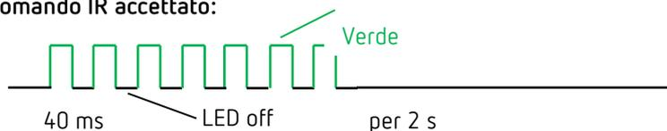
LED lampeggiante (12.5 Hz) al ricevimento di un comando di controllo remoto valido.
