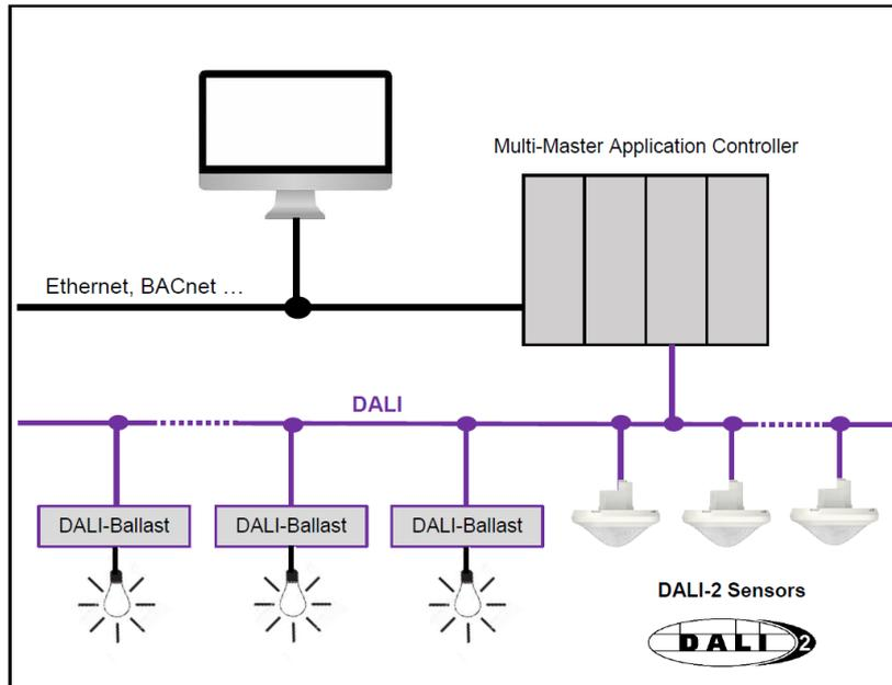
I sensori di presenza thePassa P360 DALI-2 S e altri componenti DALI vengono collegati alla linea DALI. L'alimentazione DALI viene fornita dal sistema sovraordinato. L'assegnazione di indirizzi brevi e la selezione delle istanze necessarie per i sensori di presenza thePassa P360 DALI-2 S vengono effettuate tramite Multi-Master Application Controller.
