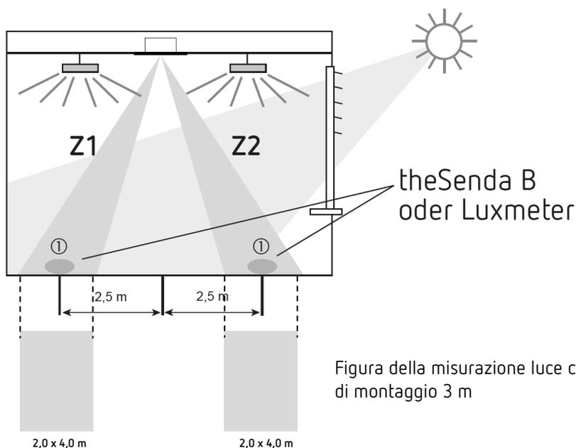
Figura della misurazione luce con altezza di montaggio 3 m
