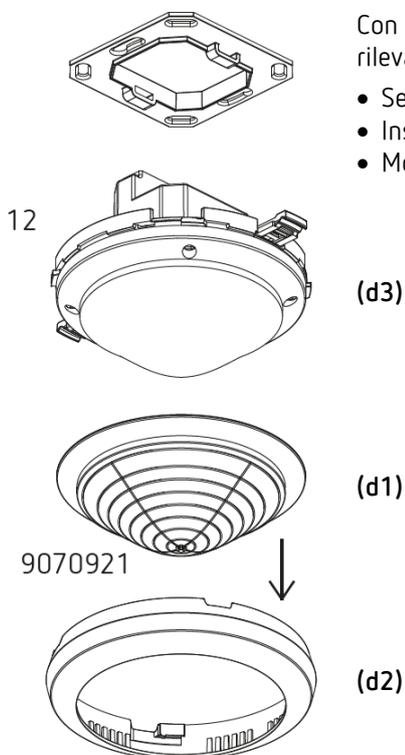
Con la clip di copertura è possibile limitare il range di rilevamento.
