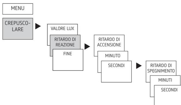
① L'apparecchio è preimpostato su **un tempo di temporizzazione ON/OFF di 1 min.**, onde evitare attivazioni indesiderate a causa di fulmini, fari di automobili, ecc. Per tutta la durata del tempo di temporizzazione, lo stato del canale ON/OFF lampeggia
