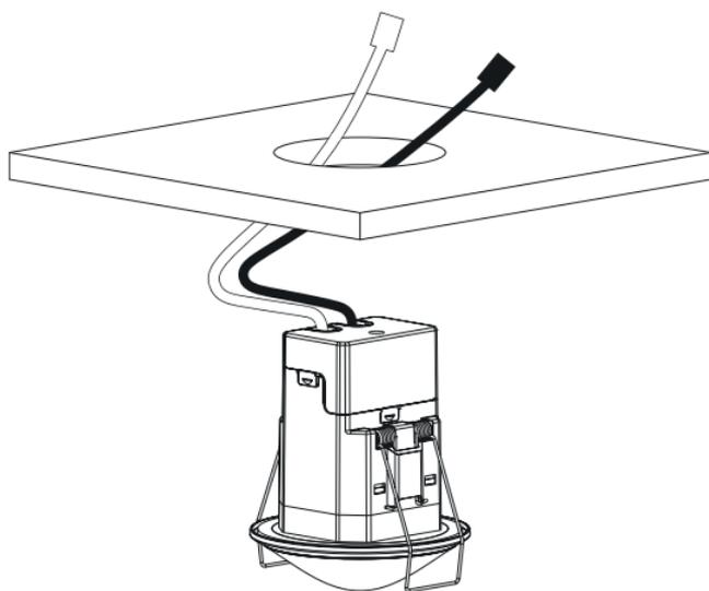
Montaggio in solai cavi per spessori di soffitto da 0,5 mm a 3 cm. Il diametro della sezione del soffitto deve essere compreso tra 62 mm e 70 mm. Il sensore necessita di una visuale libera sulle persone. L'altezza di montaggio non deve essere inferiore a 1,7 m e non superiore a 4 m.
