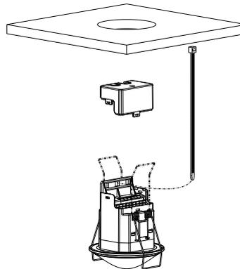
Montaggio in solai cavi per spessori del soffitto da 0,5 cm a 3 cm. Il diametro della sezione del soffitto deve essere compreso tra 62 mm e 70 mm. Lo scarico della tensione dei cavi viene ottenuto con una fascetta per cavi (larghezza da 3,5 mm a 4,8 mm).
